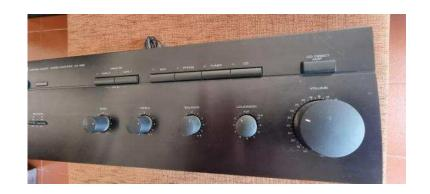
Yamaka stereo sound anni /80/90 ax390 potenza di uscita 60vat per canale su 8 Risposta di frequenza da 20hz a 20khz Distorsione armonica totale 0.04% Fattore di smorzamento 100 Separazione di canali 65lb mm 60lb linea uscita 150mv linea Dimensioni 435×146×309 Peso 8kg Chiudi
