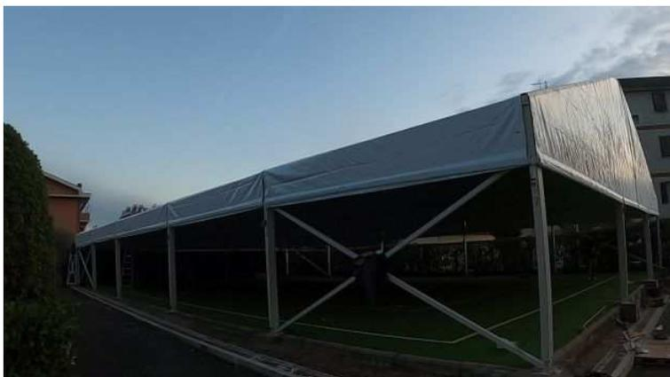
Tendostruttura in alluminio anodizzato 10x25 tetto curvo in pronta consegna, profilo principale da 121, altezza minima 3m, altissima qualità, completa di teli da 850gr/mq oscuranti per il tetto e da 650gr/mq per i laterali. Costo € 23.600 i.e. compreso trasporto. Chiudi
