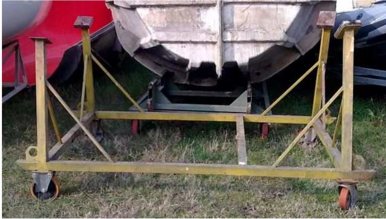
Invasatura per barca a vela con due ruote girevoli e due fisse, molto robusta, portava una barca da circa 1500 kg (Alpa 21) se interessati posso mandare un disegno con le misure. Chiudi
