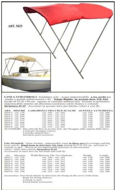
**LINEA STROMBOLI:** Tendalino sole - acqua impermeabile a tre archi per medie e grandi imbarcazioni e fly. **Telaia Rigido**, in acciaio inox 316 AISI lucido Ø 25 H 150 cm, riposo in custodia antiruggine. Tessuto in poliestere impermeabile e resistente alle intemperie. Esiste bianco e nero. **Struttura Ø 25:** Accessori in acciaio inox per barche veloci e con fly.
