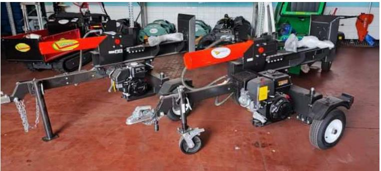
SPACCALEGNA CARRELLATO A MOTORE KOHLER DA 22 E DA 35 TON. DI SPINTA, VELOCITA' 14 '' CON RITORNO AUTOMATICO DEL PISTONE, LAVORO SIA IN ORIZZONTALE SIA IN VERTICALE , GANCIO TRAINO PER SPOSTAMENTI NON OMologATO STRADALE .
