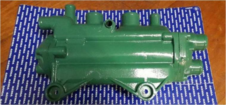
Scambiatore di calore per D3-160 HP tipo vecchio.
